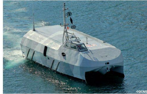
Espadon, un démonstrateur de drone de surface qui embarque des drones sous-marins - DCNS
