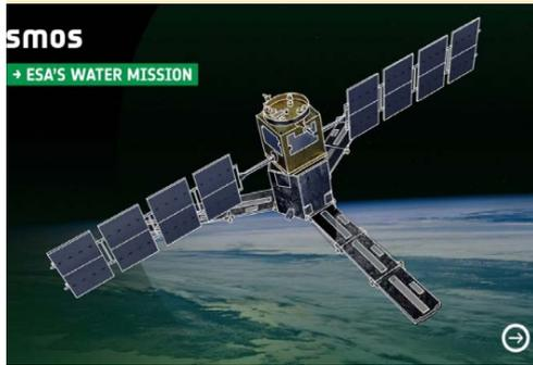
La mission **SMOS** embarque l'instrument **MIRAS** Microwave Imaging Radiometer with Aperture Synthesis - un radiomètre micro-onde imageur en bande L dont le principe observationnel repose sur l'interférométrie et la synthèse d'ouverture.
