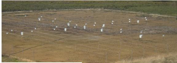
Le radar VHF (Very High Frequency) à 45MHz dont l'antenne co-co (colinéaire-coaxiale) est constituée par deux réseaux de câbles orthogonaux (60 x 60 m<sup>2</sup>).
